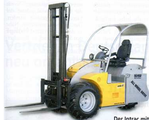
Der InTrac mit Dreirad und Allradantrieb.
